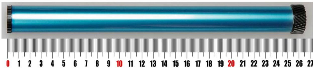
3. Покрытие на барабане прозрачное (свет отражается от алюминиевой поверхности барабана), это покрытие имеет при обычном освещении синие оттенки.
